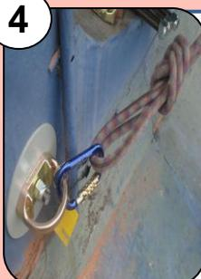
Conecte el equipo de descenso a un anclaje, instale la cuerda en el mismo y conecte directamente la línea de vida a otro punto
